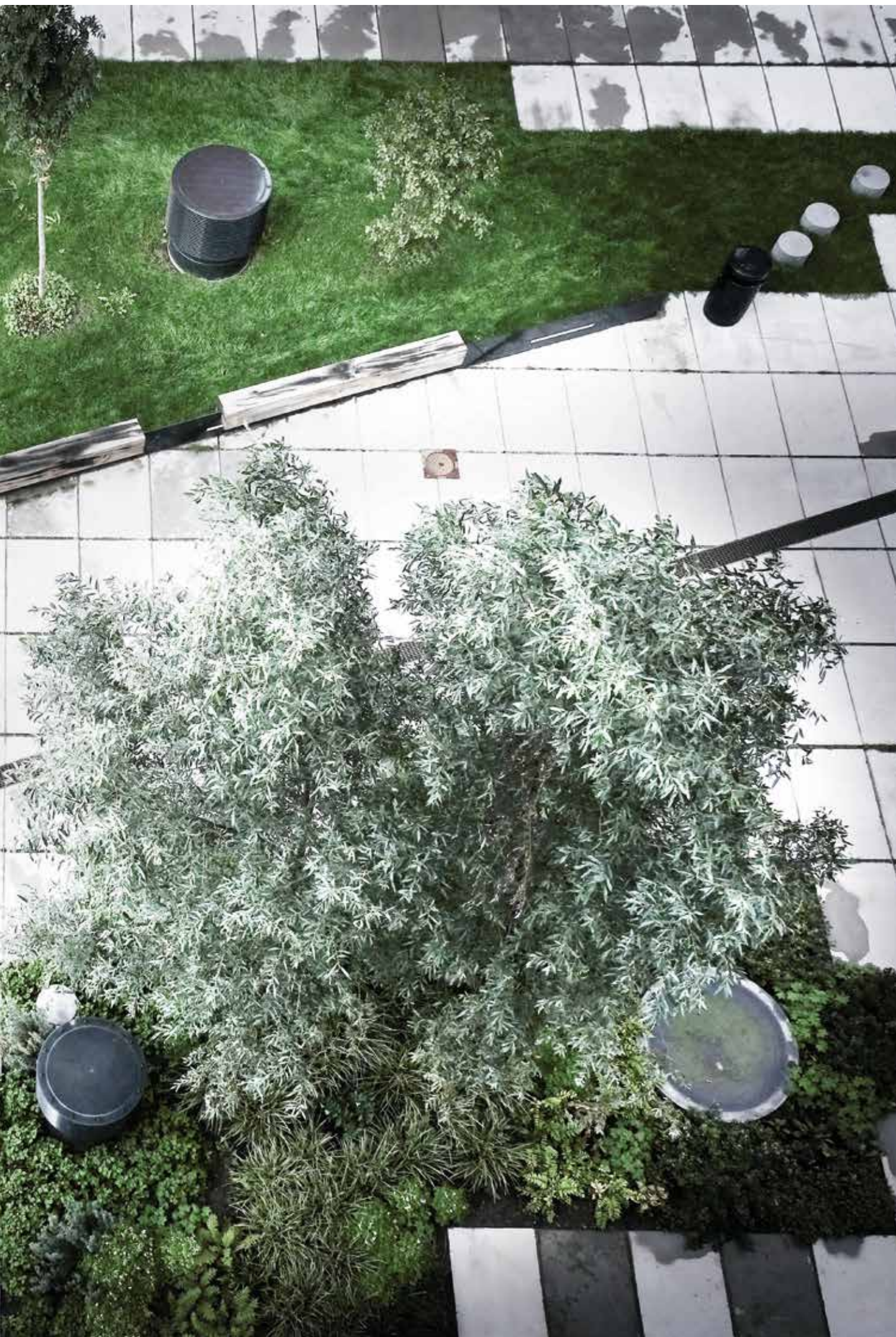
Fortællingen om havnemiljøet bæres frem i insitustøbt betonbelægning med brede græsfuger. The history of the harbour is reflected in concrete pavement cast in situ with wide grass divides. Foto/Photo: Jacob Fischer.
