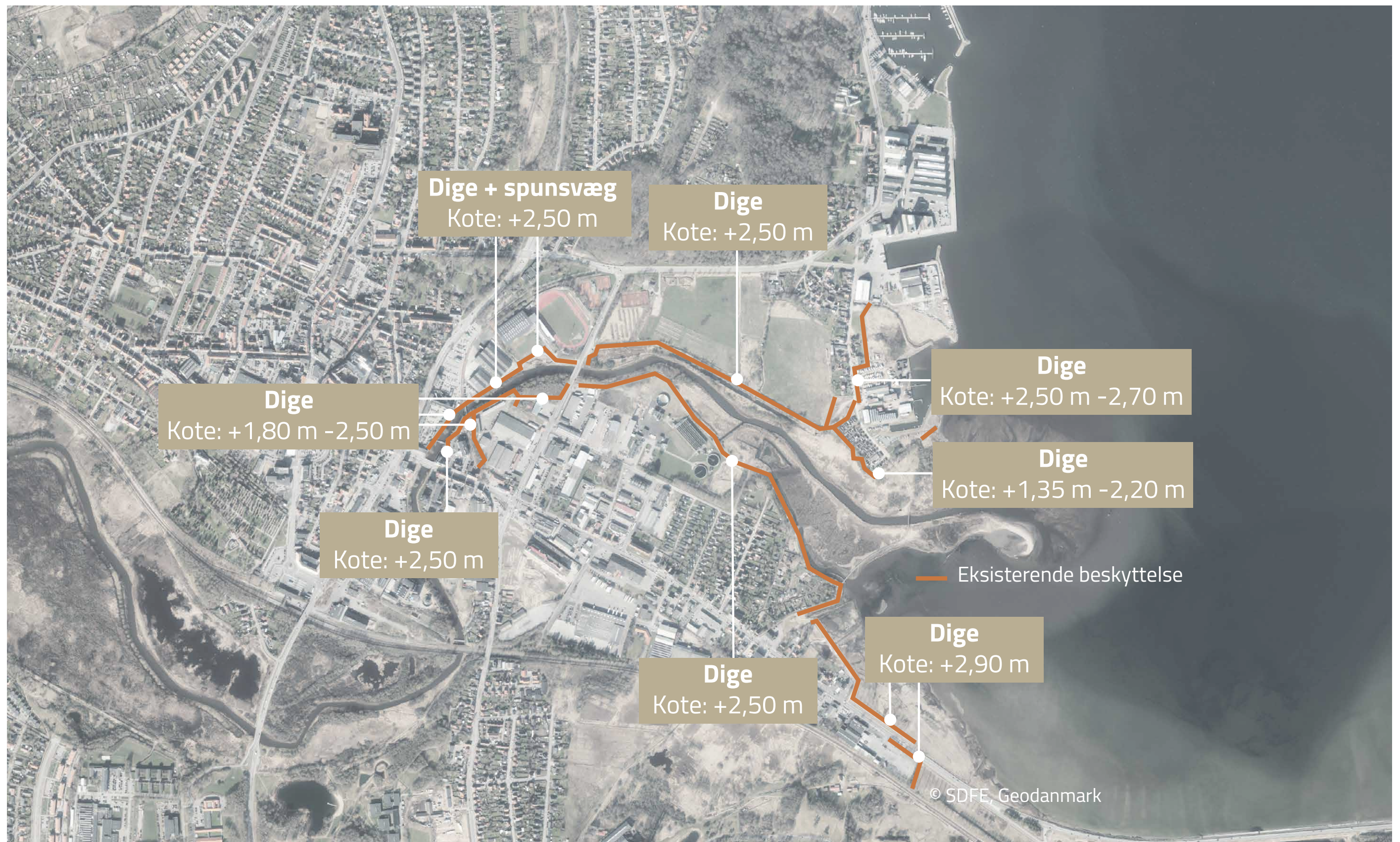
Placering af eksisterende højvandsbeskyttelse i form af diger langs Karup Å. Den eksisterende digehøjde er ligeledes angivet.
